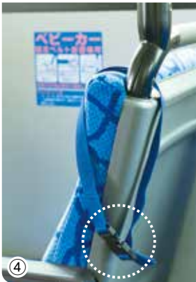
①運転席には計器がいっぱい ②交通系ICカードを利用できる ③座席を折りたたむと車いすを固定するスペースができる ④ベビーカーを固定するベルトを設置 ⑤窓が大きく明るい車内 ⑥車いすで乗り降りできるようスロープを完備 ⑦優先席はデザインで表示
