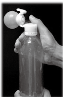
雲づくりの様子 ※講師が準備するポンプ付き加圧キャップを装着したペットボトル
