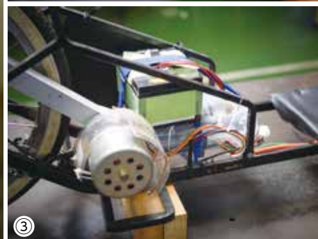
①CADで設計図を作成 ②デジタルノギス(測定器)で寸法を正確に測る ③電気自動車の動力源となるモーター ④集中して旋盤やフライス盤を自在に操る ⑤溶接後の確認作業 ⑥モーターにつながる電気系の作業 ⑦きれいに整理された工具
